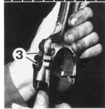
Riferimenti bielle-stantuffi 1. Spruzzatore olio - 2. Riferimento alesaggio teste bielle - 3. Riferimento diametri cilindri
