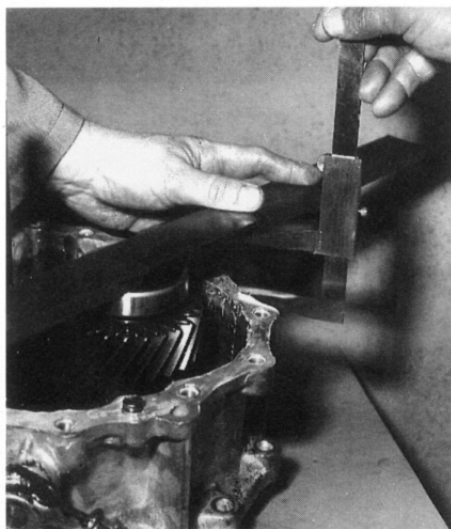
Misurazione sporgenza albero intermedio per determinazione cavo registrazione
