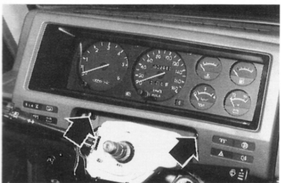
Viti fissaggio manicotto strumentazione (Patrol 260)
